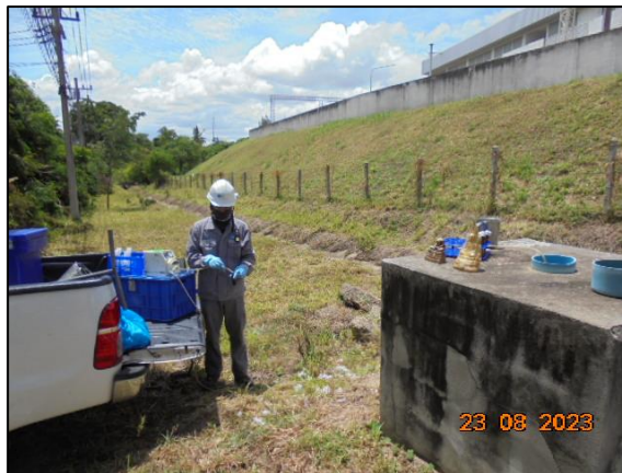
รูปที่ 3.20 การเก็บตัวอย่างคุณภาพน้ำใต้ดิน บริเวณพื้นที่โครงการ Down Gradient (UW4)
