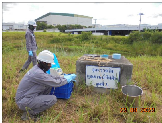
รูปที่ 3.21 การเก็บตัวอย่างคุณภาพน้ำใต้ดิน บริเวณพื้นที่โครงการ Down Gradient (UW5)
