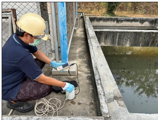
รูปที่ 3.9 การเก็บตัวอย่างคุณภาพน้ำเสีย บริเวณ บ่อสูบน้ำเสีย
