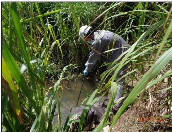
รูปที่ 3.15 การเก็บตัวอย่างคุณภาพโลหะหนักในตะกอนดิน บริเวณ อ่างเก็บน้ำห้วยสะพาน (S1)
